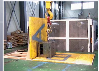
▲ 반전을 위하여 "A"판을 세우고 금형을 올려 놓은 상태 Mold is put on the plate "B" after lifting the plate "A"
