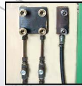
코어작동테스트를 위한 유압 원터치 커플링 One-touch hydraulic couplings allowing for test of slide cores
