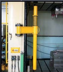
슬라이드가 상승된 상태에서 안전하게 작업할 수 있도록 양쪽에 안전바 설치 Additional 2 safety bars for all safety failure prevention
