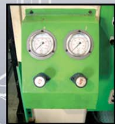
금형보호를 위하여 스폿팅 작업을 무부하까지 가능하게 하는 밸런스 하강 시스템 Remote control valve supporting prevention of molds from too excessive spotting
